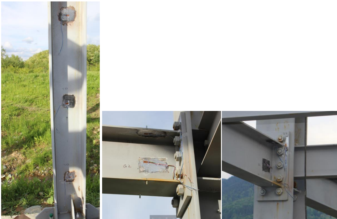
Fig. 1 Dispunerea timbrelor tensometrice pe stalpi (stanga) grinzi (mijloc) și plăci de capăt (dreapta)
